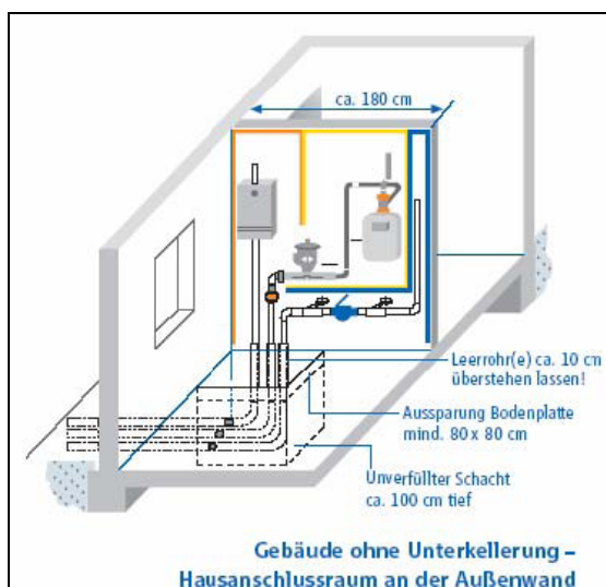
Hausanschlussraum in einem Gebäude ohne Keller sowie Hausanschlussnische
